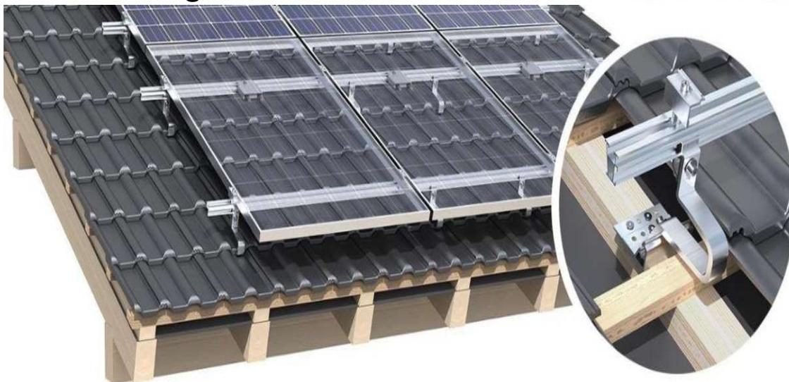
Die Platten werden dann auf die Schienen gelegt und mit Klammern befestigt. Jedes Paneel wird mit seinem Nachbarn verbunden und die Verkabelung wird an den Schienen befestigt und mit Kabelbindern gesichert.
