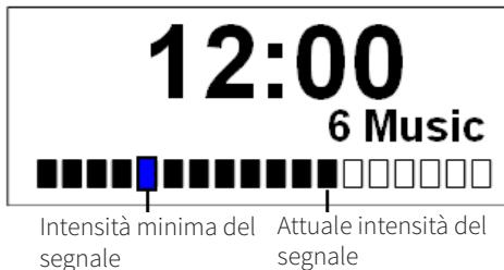
Per verificare l'intensità della ricezione di un singolo transponder procedere come segue:
